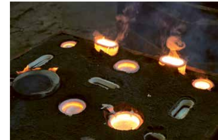
(Bild 3) Den exotermiska reaktionen hos Feedex-NF-1-matarnas syns tydligt
