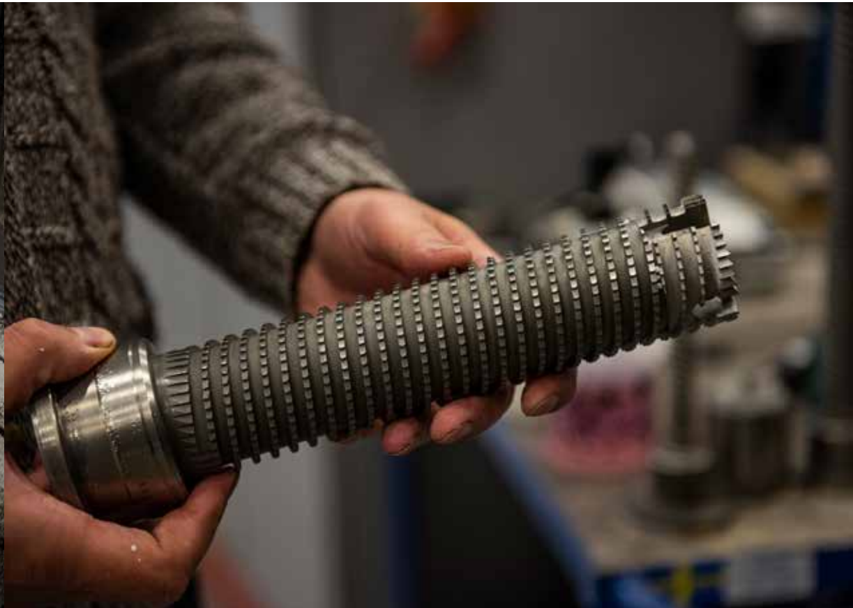
Fräsverktyg till frigolit. Ihålig så att extramaterial sugts upp. Spill går till uppsamling och formas till briketter som skickas tillbaka till leverantören.
