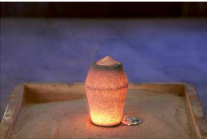
(Bild 4) Konstant förbränning i en matare
