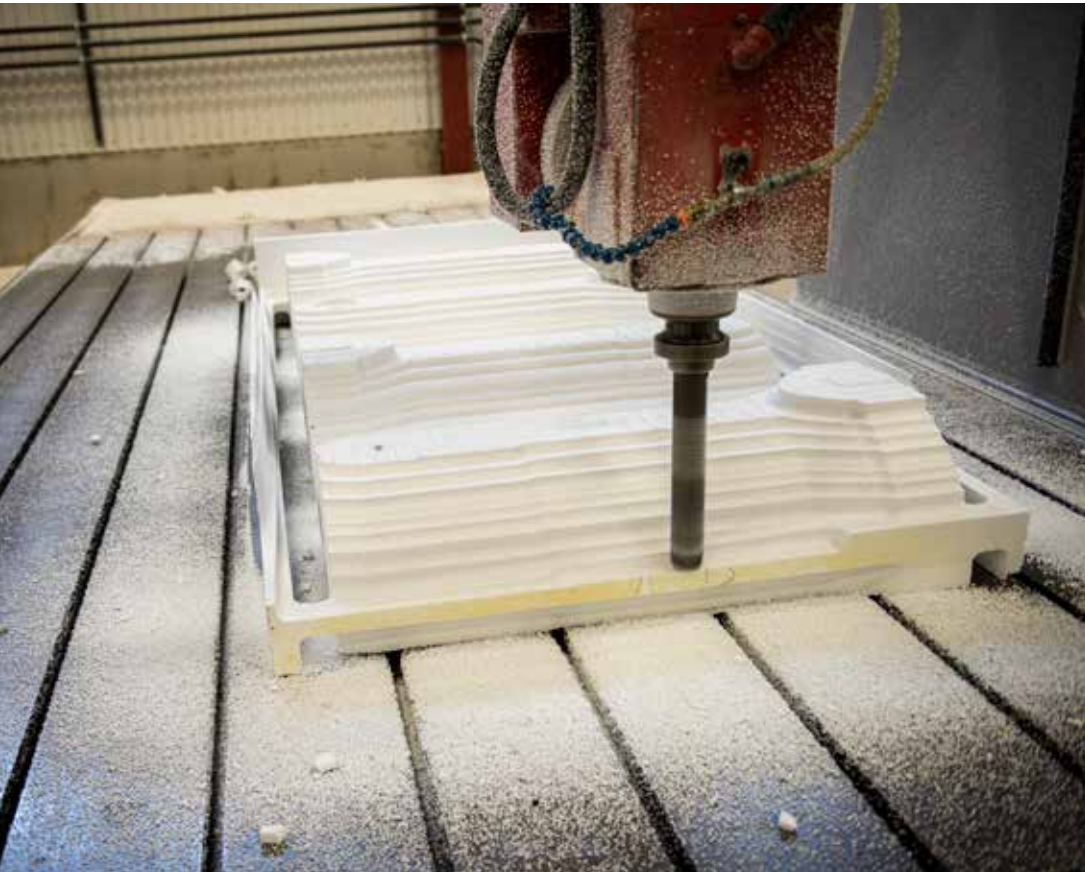
Formar till Norrlandsgjuteriet ligger i fräsnigen
