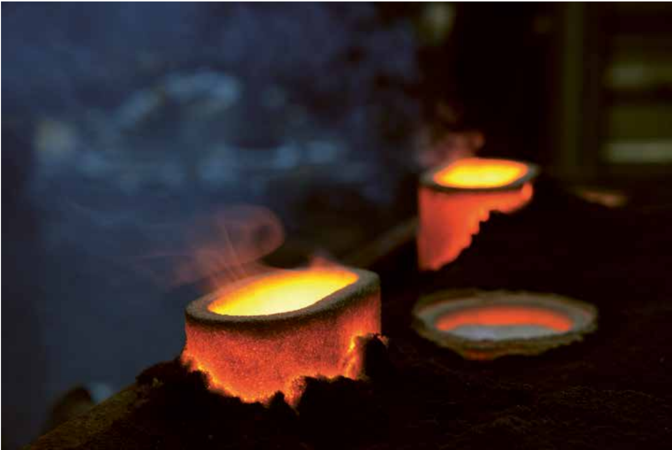
Nyhet för icke-järnmetallgjuterierna. De exoterma matarna Feedex-NF-1
