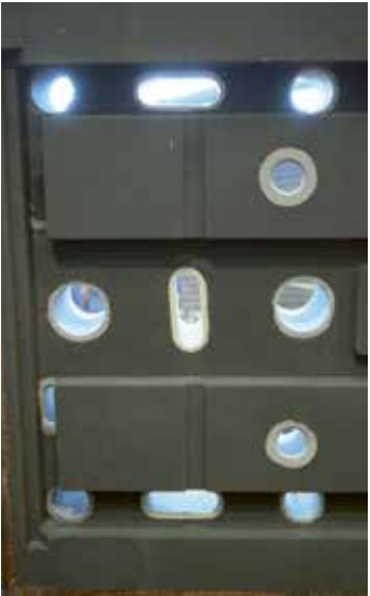
(Bild 2) Exotermiska och isolerade matare placerade i en form
