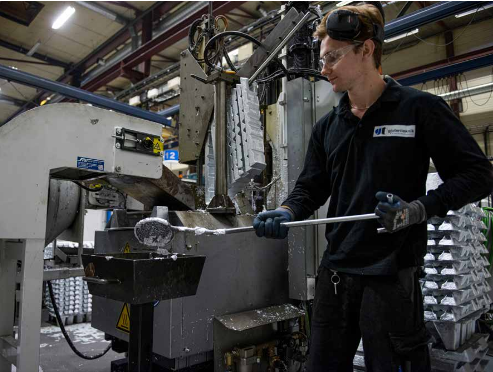
Om man inte slaggar av ordentligt kan slagget fastna och i värsta fall stoppa bandet.
