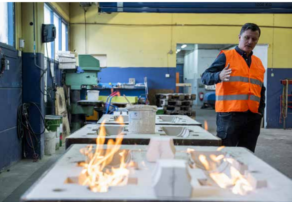
Formarna bränns ur för att preparera ytan. Anders Carlsson bär utrustning för att mäta kvartsmängd i luften. Leif visar var blästern ska stå.
