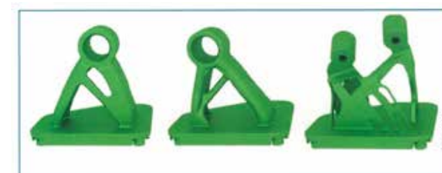
Olika utformningar av lasersvetsat fäste för en servostyrningspump. (Bild 3)
