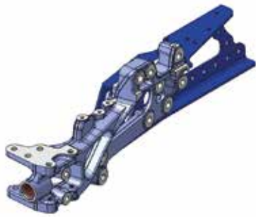
Utveckling för förstärkning av ett hyttfäste: Ramdel med ett hyttfäste, Utgångsformning, utformning i segjärn. Viktminskning 15% (Bild 4)
