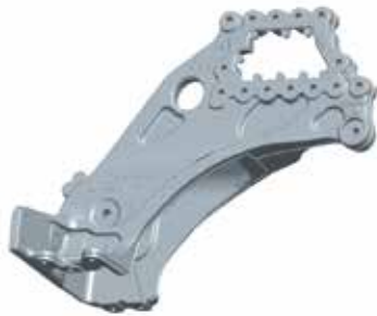
Utformning av ett främre fjäderfäste. Material: EN-AC-AISI10MgT6. Viktminskning 30% (Bild 5)
