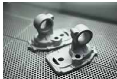
Nya konstruktioner kan tas fram som prototyper med additiv tillverkningsteknik innan de serietillverkas
