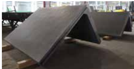
L-stöd i betong tillverkade av Svenska Cement med sand från Holsbyverken i projektet ÅGREN
