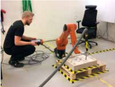
Roboten i arbete med att dammsuga sand.
