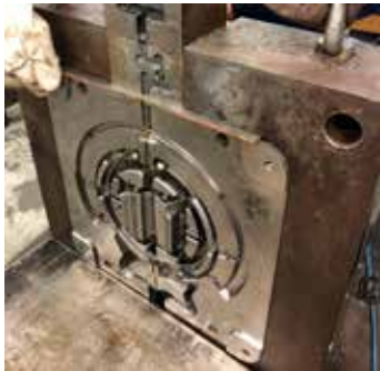
BILD på CAD verktyget med kanaler och den färdiga insatsen till pressgjutverktyget i ADDING II.
