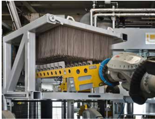
Efter uttagning av kärnan ur kärnskjutmaskinen avgrädas kärnan med en robot i detta verktyg
