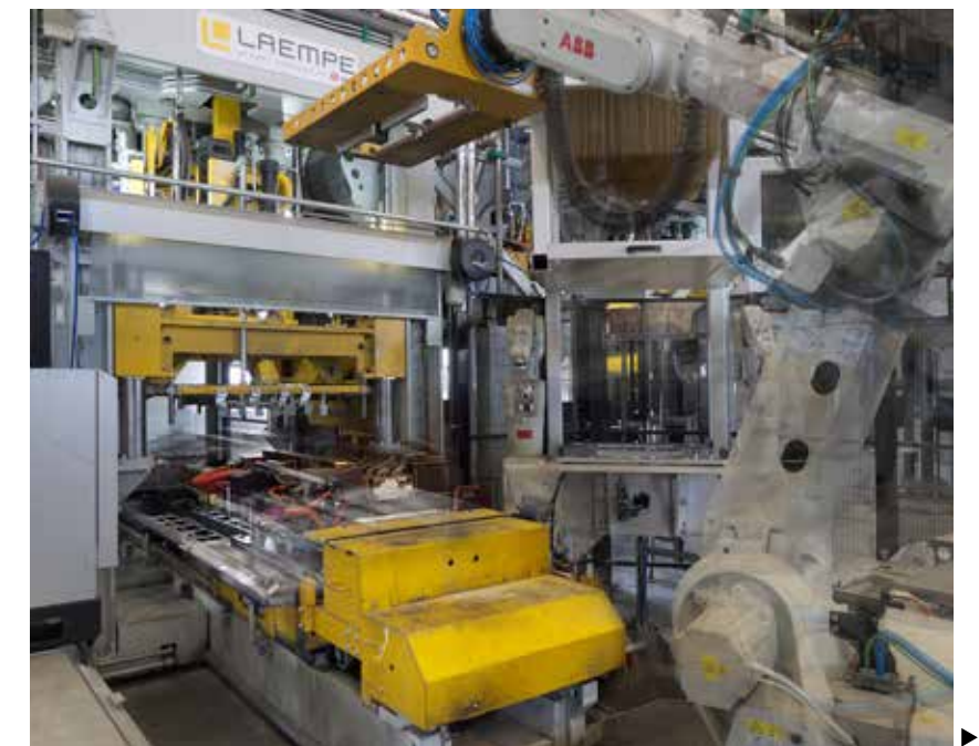
En färdig kärna lämnar kärnskjutmaskinen.
