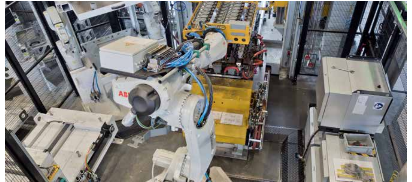
Helautomatisk kärntillverkning. Industrirobotar övertar i praktiken alla arbetsmoment efter kärnskjutningen.
