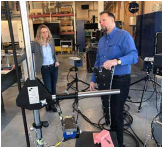
Andreas Linderholt visar hur lasersystemet fungerar när det mäter vibrationer.
