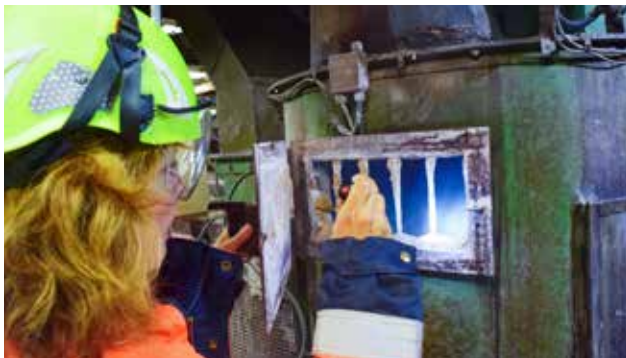
Britt Förnegård kontrollerar blandningsförfarandet i skalsandsblandaren.
