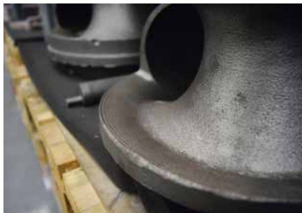
Om man tittar närmare på ett gjutgods kan man se att kärnan är gjord i en 3D-printer via "årsringarna" som finns på godset.
