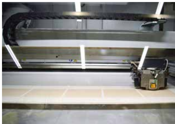
3D-printern är i igång med kärnbygge. Varje lager är 0,28 mm.
