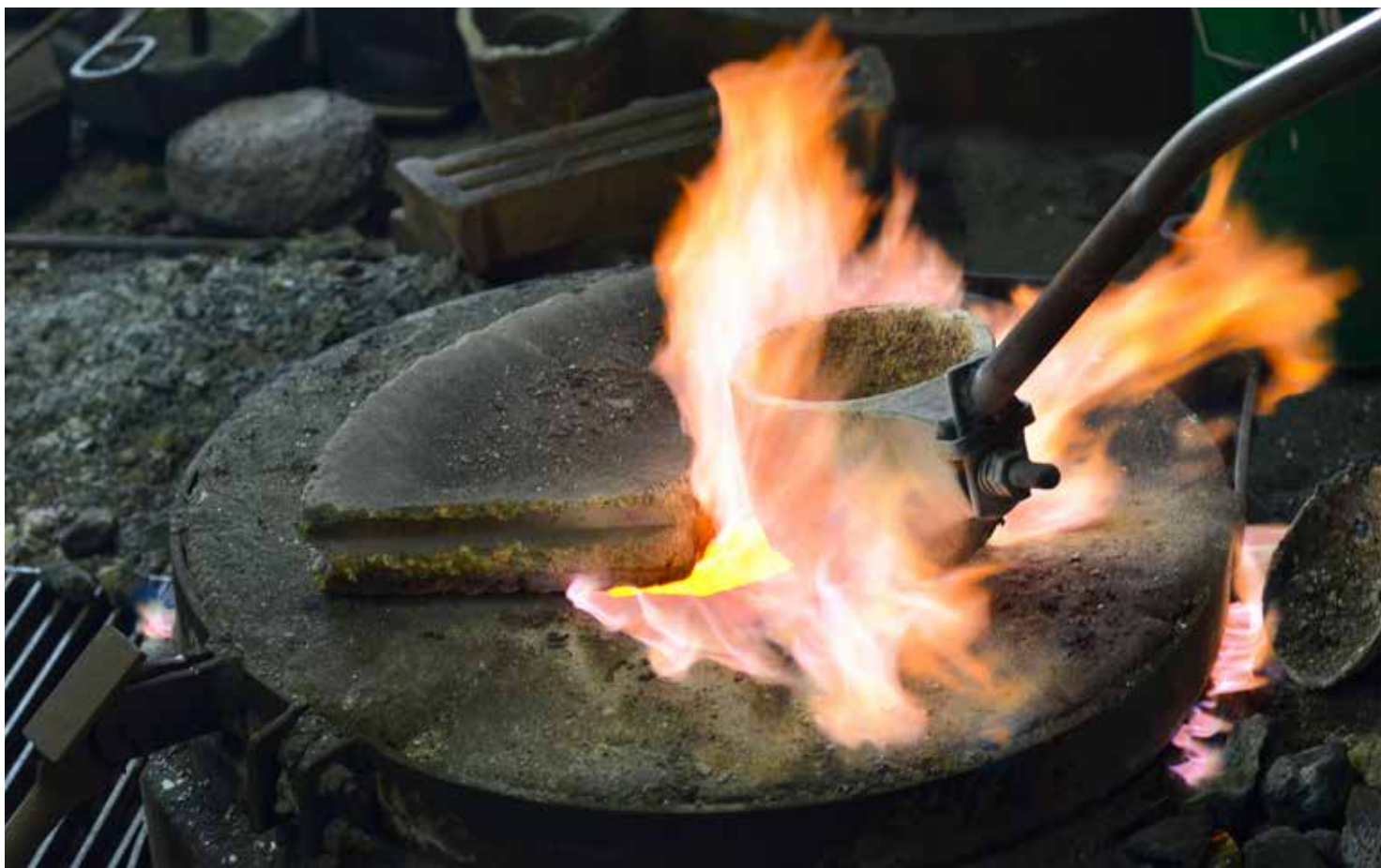
Ove jobbar mest med rödmetall men även fosforkoppar som gör att smältan rinner lättare.
