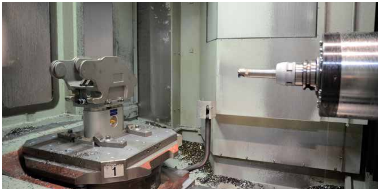
I palettmaskinen sker bearbetning för att fästet ska passa mellan maskin och redskap.
