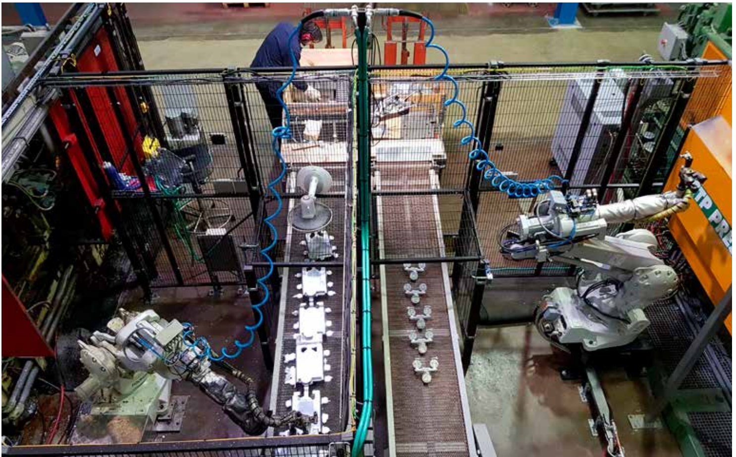
En av Blekinge Pressgjuteris senaste investeringar är två nya automatiserade gjutceller som hanteras av en operatör.
