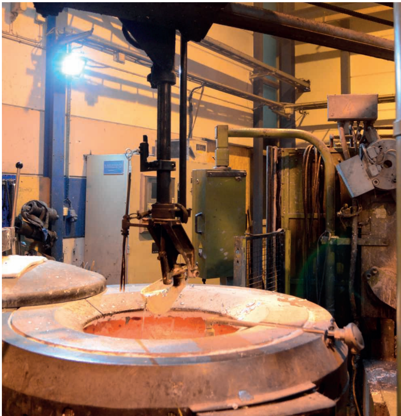
Smält aluminium i en skopa som snart ska hällas i maskinen.
