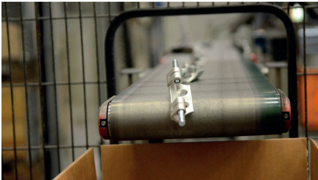
Zinkgjutna gångjärn på Gjuteriteknik i Värnamo.
