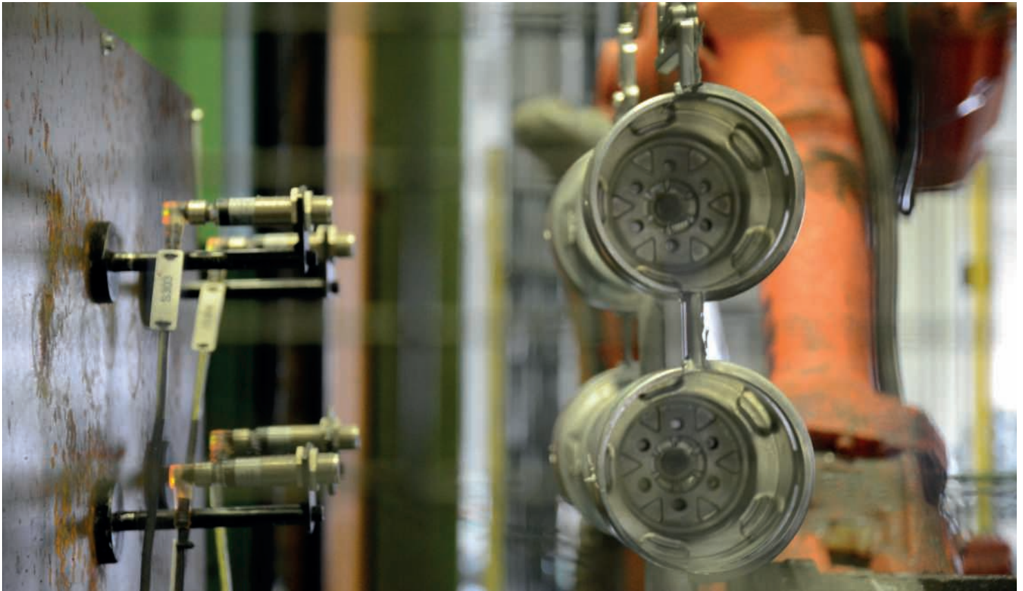
Roboten håller upp de gjutna komponenterna för kontroll. Automatiserad avsyning är ett måste för att möta kundernas krav.
