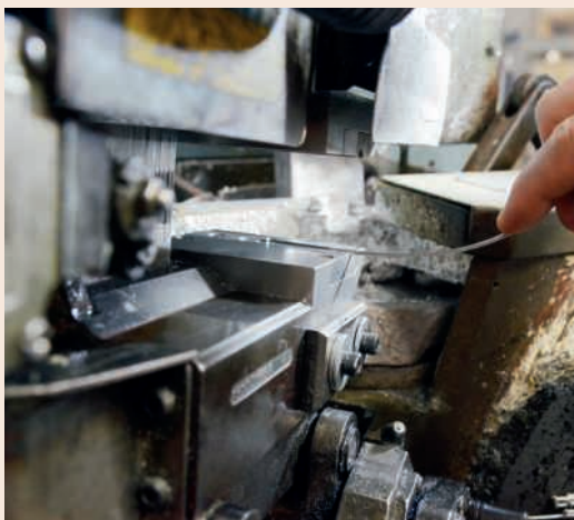
Gjutning i liten pressgjutmaskin på WR Controls.
