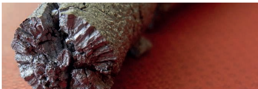
Brottytan på en stav som gått sönder på grund av tennpest.
