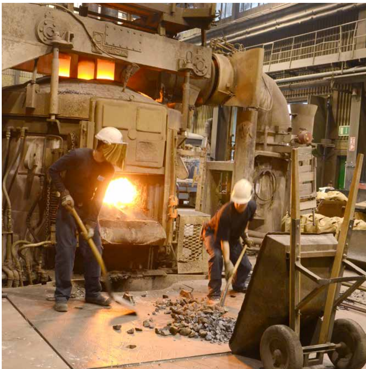
Morgan Johansson och Fredrik Pettersson gör sig redo för att ladda ljusbågsugnen med nytt legeringsmaterial. De tre elektroderna syns glödande strax ovanför ugnen.
