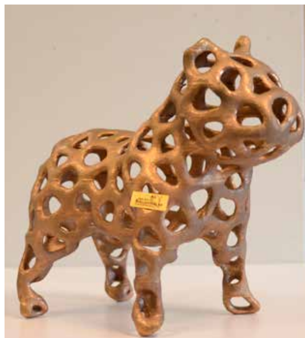
Hunden Bronzo – ett exempel på de geometrier som kan tas fram med hjälp av additivt tillverkade former och kärnor.
