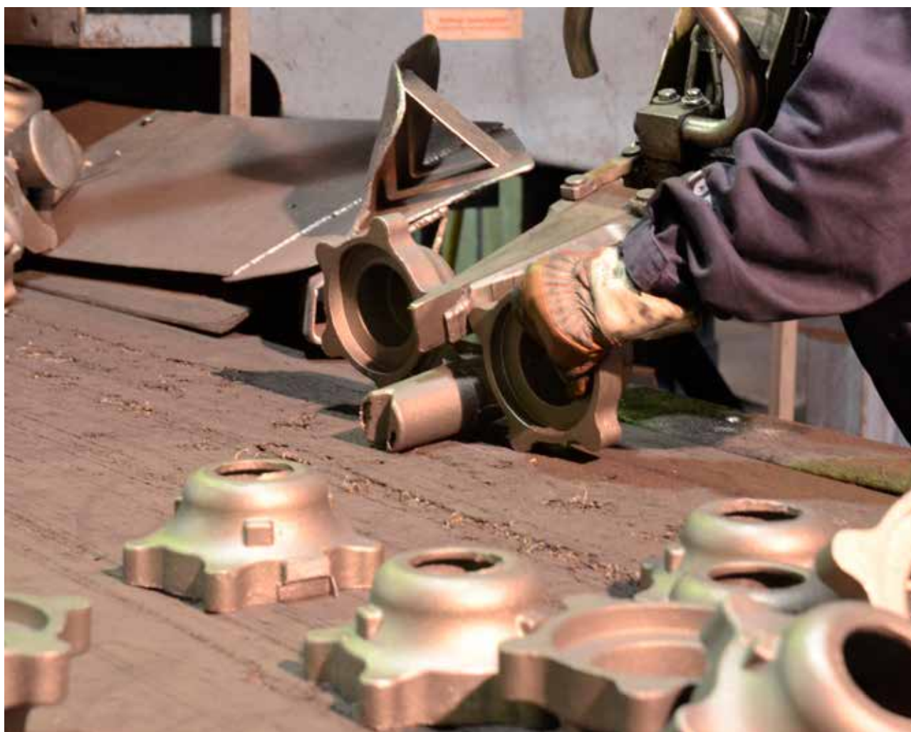
Genom att tänka till vid designen är det lätt att slå av ingjutsystem med ett hydrauliskt verktyg utan att behöva kapa.
