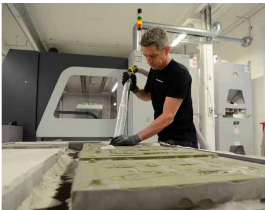
Andreas Lindberg Pruth vid Swerea SWECAST blåser rent nyttskrivna former och kärnor från 3D-printern.
