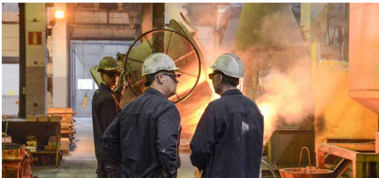
Dags för tappning till avgjutningsskänken. I Vetlanda finns tre ugnar på vardera 5 ton.
