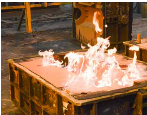
Här bränns den spritbaserade blacken från en av bolagets formar.
