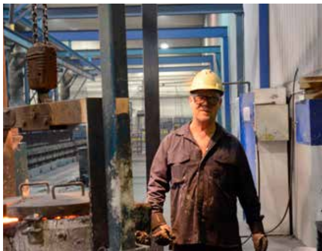
Pelle Folkesson har gjort i ordning en mindre avgjutningsskänk och väntar nu på att smältan ska bli klar.
